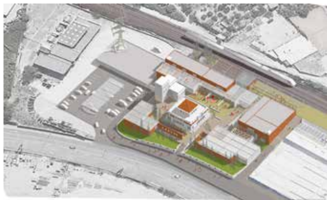
Izometrijski prikaz cjelokupne zgrade s fotonaponskim ćelijama i željezničkom stanicom. Kodlove trafostanice su u bijeloj boji i imaju ulogu kao središte i jezgra samog kompleksa.
